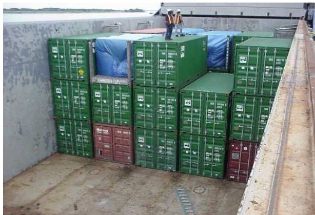
Figura 1- Layout dos porões de navios mercantes
